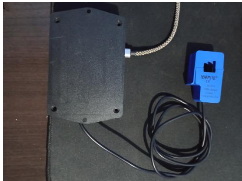
Figura 9 - Compartimento do circuito com tampa e sensor SCT-013 não invasivo.
