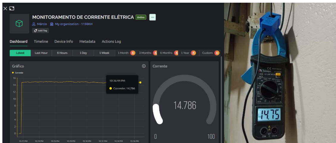
Figura 25 - Comparação do alicate amperímetro e sensor SCT-013 após calibração.
