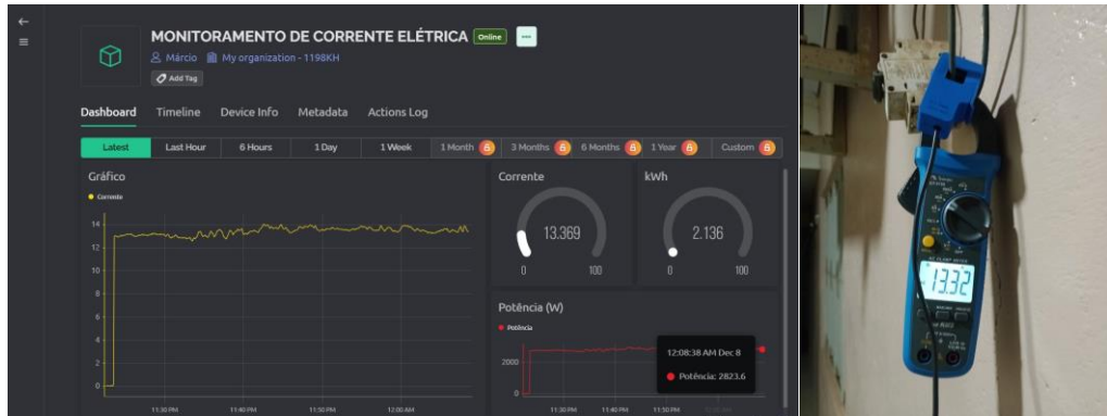
Figura 33: Monitoramento da corrente durante 45 minutos com sensor SCT-013 e alicate amperímetro.
