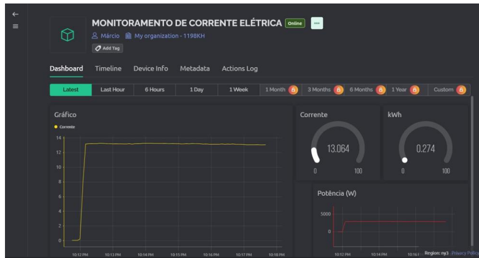
Figura 27: Nova interface do sistema com a implementação da potência e consumo do equipamento.
