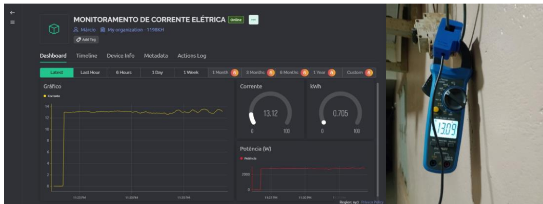
Figura 32: Monitoramento da corrente durante 15 minutos com sensor SCT-013 e alicate amperímetro.
