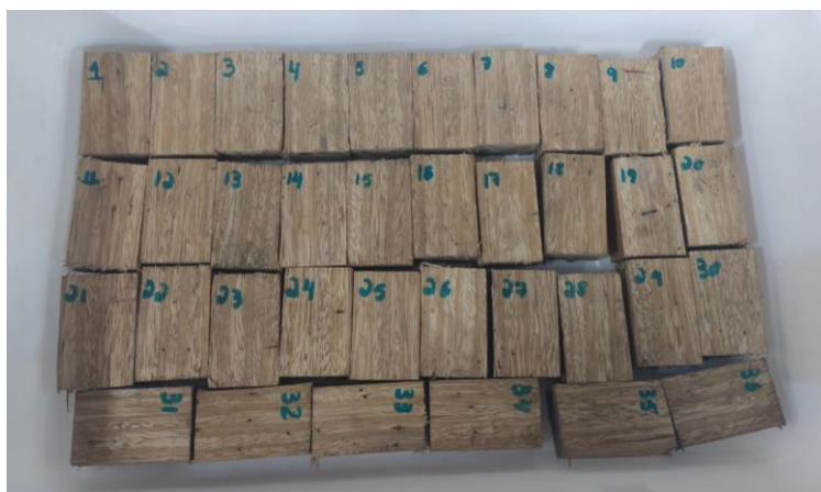
Figura 3 - Corpos de prova confeccionados e pesados antes de serem submetidos à secagem em estufa.
