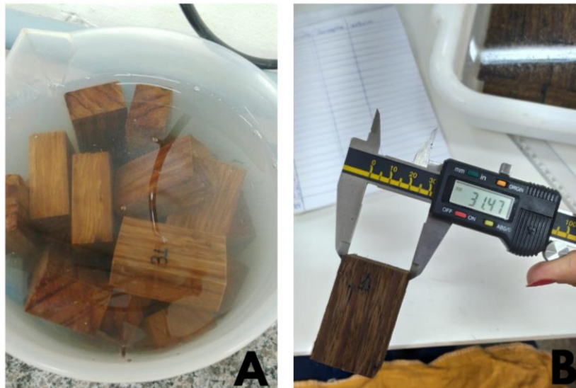
Figura 10 - A: Corpos de Prova no processo de saturação; B: Medição das dimensões da madeira saturada com paquímetro digital para determinação da retratibilidade.
