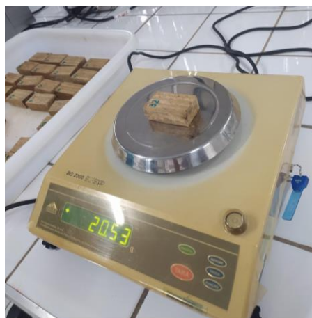
Figura 4 - Determinação da massa inicial dos corpos de prova em balança semi analítica.
