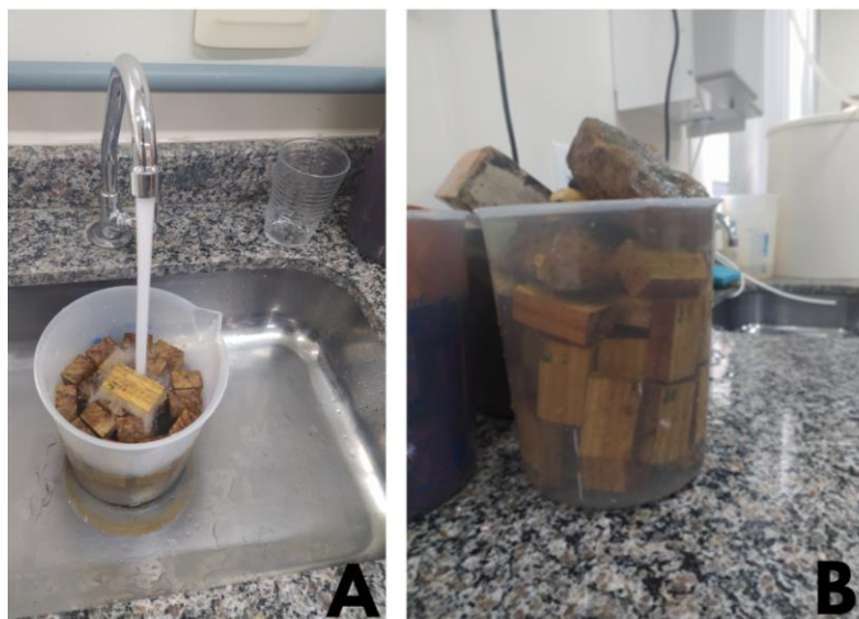
Figura 7 - A: Início da Saturação; B: Corpos de prova em processo de saturação.
