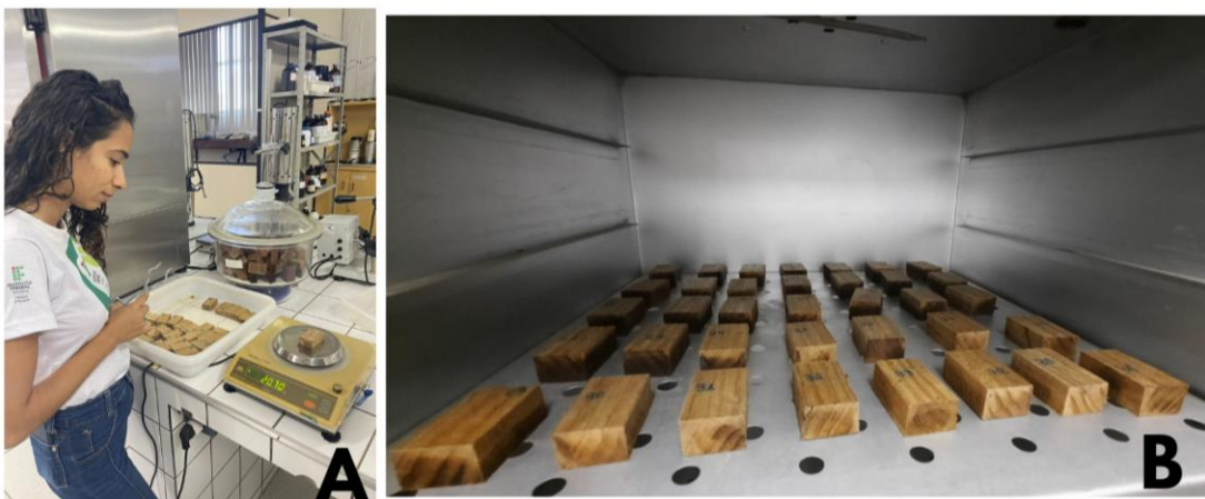
Figura 6 - A: Monitoramento do processo de secagem; B: Corpos de prova em processo de secagem em estufa.
