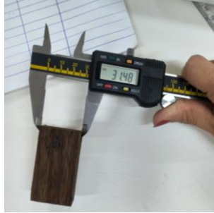
Figura 8 - Medição das dimensões da madeira saturada com paquímetro digital para determinação da densidade.
