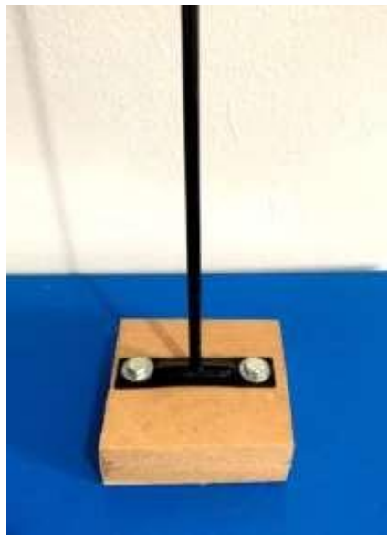
Fotografia 01: Haste maior presa na base de madeira
