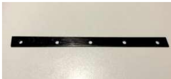
Fotografia 05: Barra metálica que compõe o pêndulo físico
