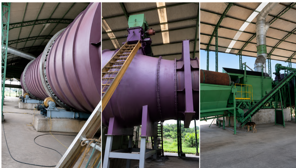
Figura 3.3- Maquinário utilizado no processamento do caroço de açai para separação das fibras do mesocarpo fibroso por secagem e ação mecânica. (Fonte: Imagem fornecida pela empresa Popinhak Açai, 2023).
