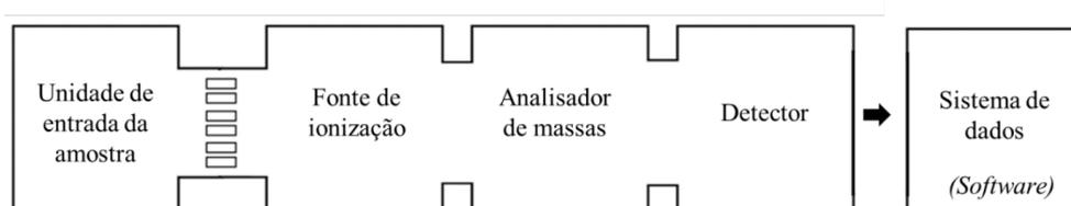
**Figura 10** – Componentes de um espectrômetro de massa. Figura adaptada (PAVIA et al., 2015; GROSS, 2011).
