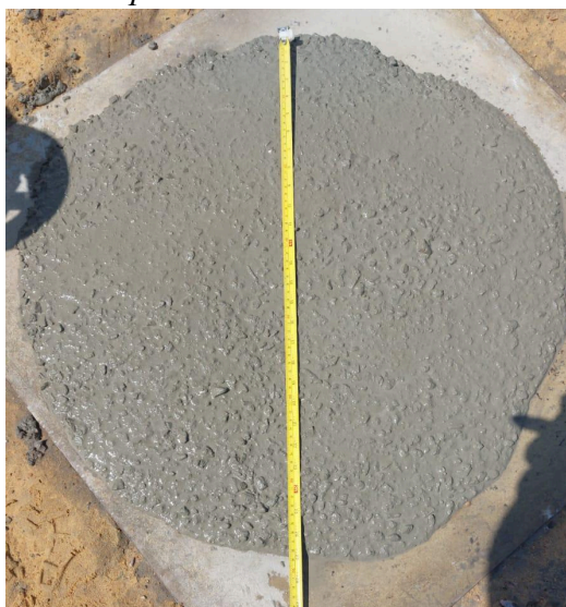
Figura 4.15 – Slump Flow com concreto na fluidez adequada.
