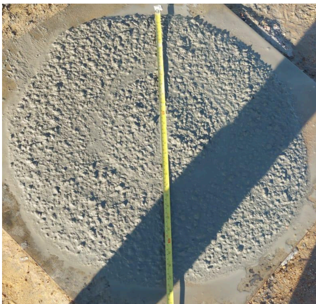
Figura 4.17 – Concreto com Índice de Estabilidade Visual classificado como Estável
