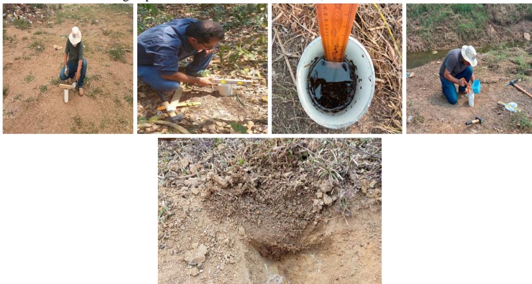
Figura 10. Exemplo de Cilindro metálico e medição da infiltração em campo, realizado na porção montante do igarapé Grande na cidade Porto Velho, Rondônia, Brasil.
