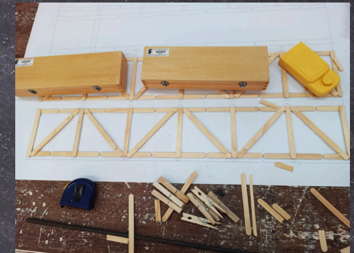
Foto 5 - Detalhe de pesos colocados para pressionar as diagonais
