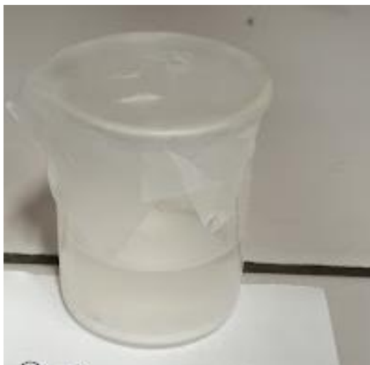
Figura 12 – Precipitado branco observado para formação do salhid
