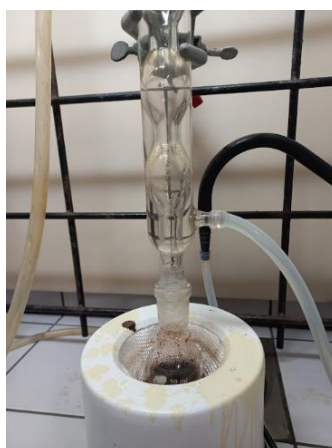
Figura 18 – Sistema de refluxo em etanol.
