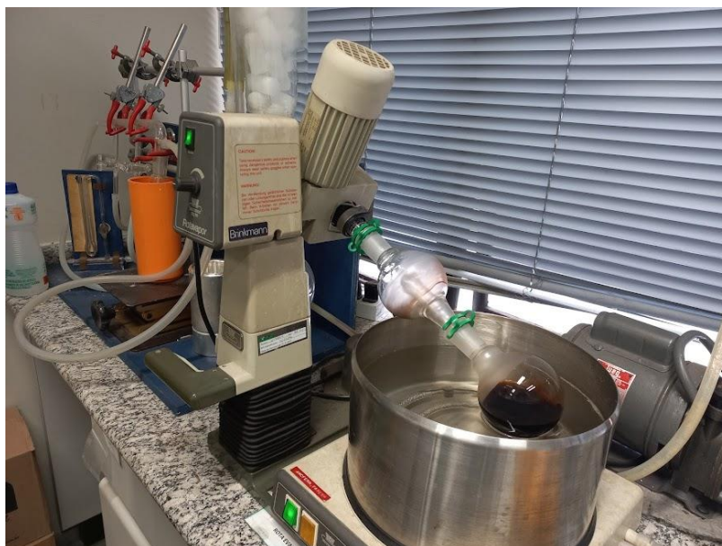
Figura 17 – Submissão do sobrenadante do sistema Cu- pirhid ao sistema de rotaevaporação.
