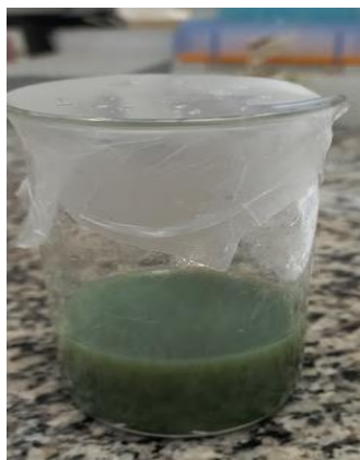
Figura 14 – Sistema esverdeado pela complexação de íons \text{Cu}^{2+} por pirhid .
