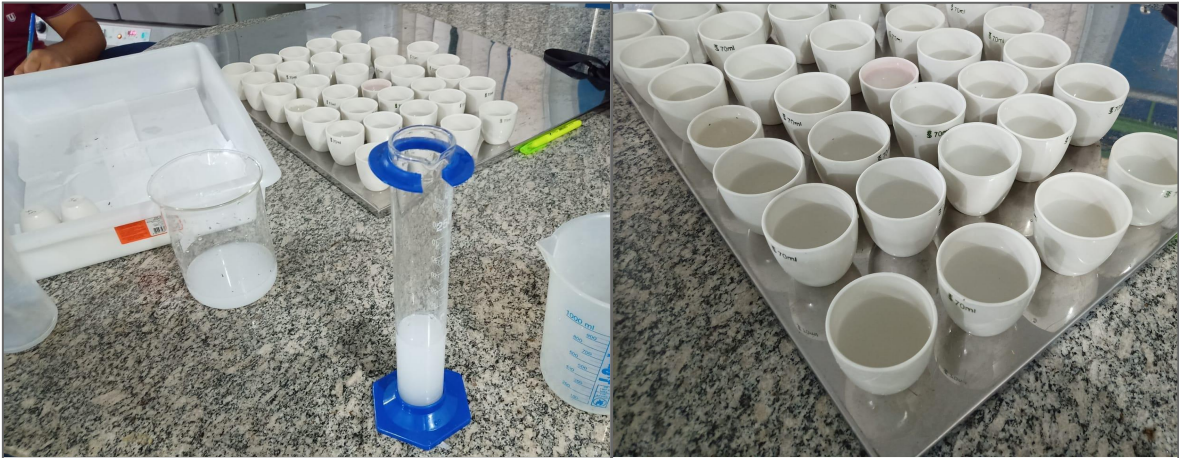
Figura 8 e 9: Aferição volumétrica das amostras e distribuição em cadinhos.
