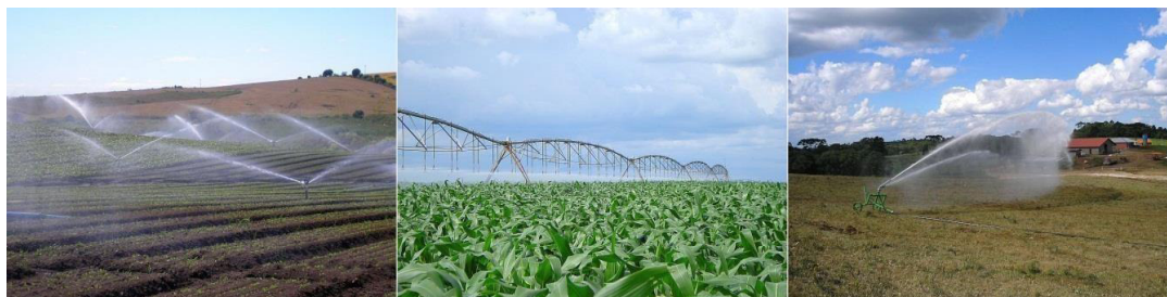
Figura 2: Exemplos de sistemas por aspersão: estacionário (esquerda), móveis manualmente (direita) e mecanizadas por pivô central (centro).
