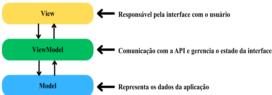
Figura 4. Padrão de arquitetura MVVM aplicado ao aplicativo Android
