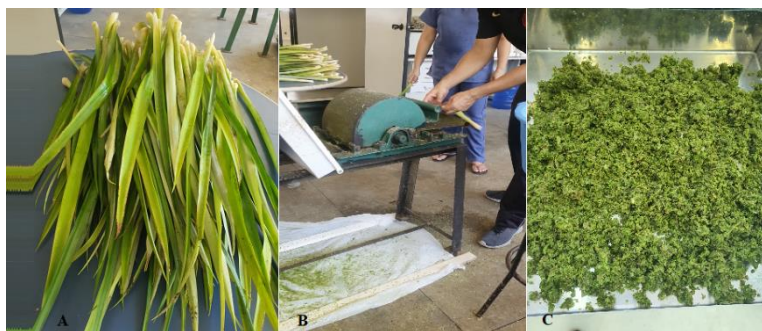
Figura 7. a) folhas de Curauá b) Processo de desfibramento c) Mucilagem de curauá úmida.
