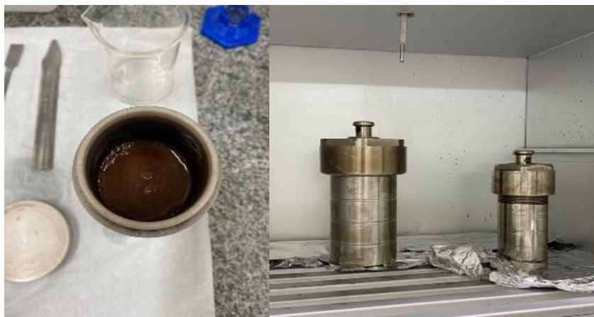
Figura 9. Processo de preparo dos hidrocarbões em reator hidrotérmico.
