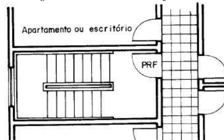
Figura 36: Escada enclausurada Protegida - EP
