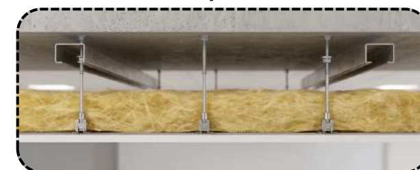
Figura 23: Representação Esquemática de trecho do forro com isenção de lã de vidro.
