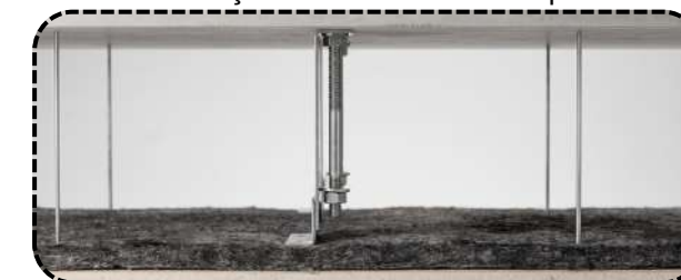
Figura 24: Representação Esquemática de trecho do forro com isenção do feltro de betume prensado.
