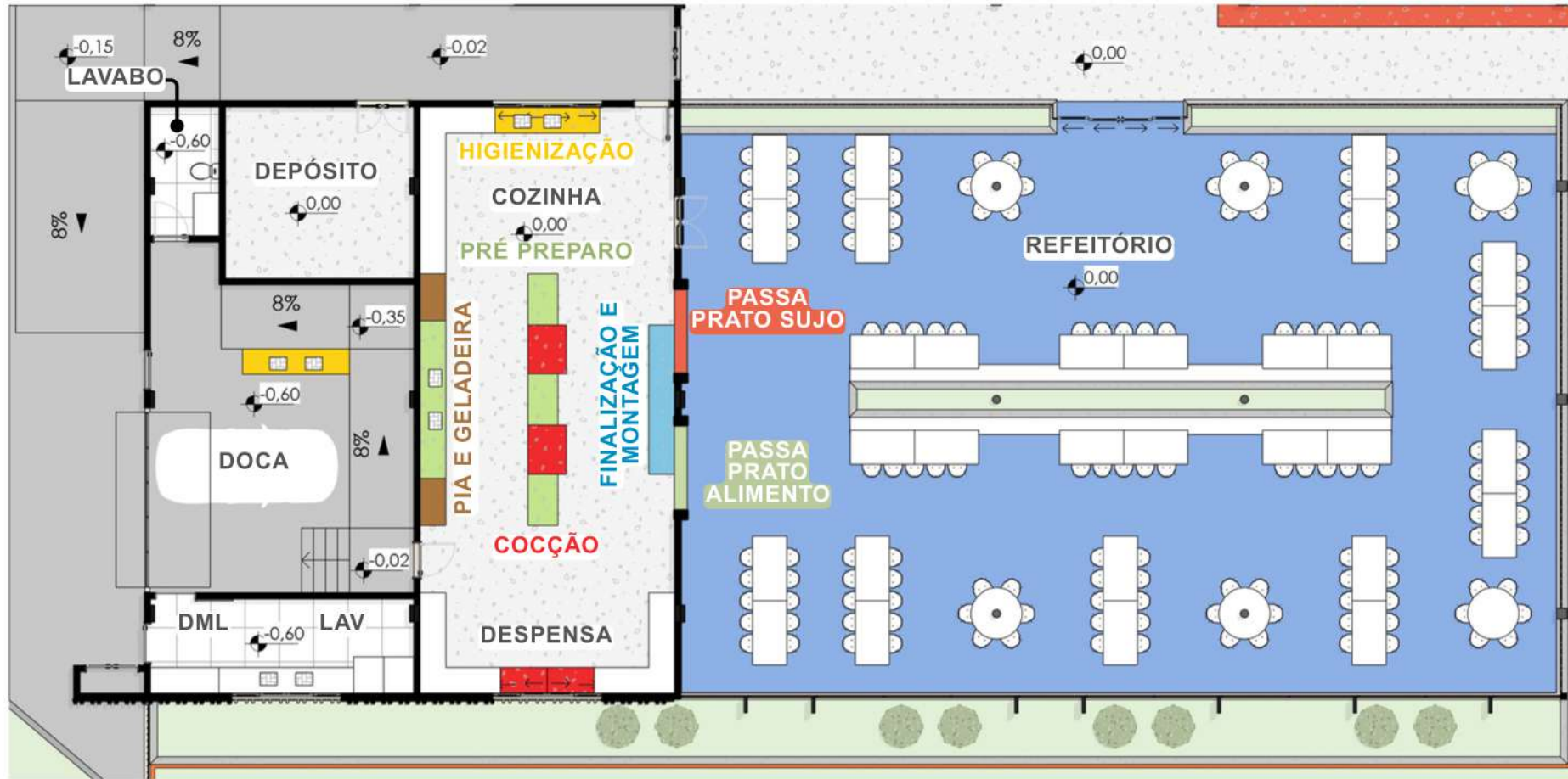
PLANTA BAIXA LAYOUT SERVIÇO/COZINHA/REFEITÓRIO
