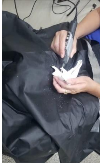
Figura 4 – Processo de limpeza realizado com o aparelho polidor.
