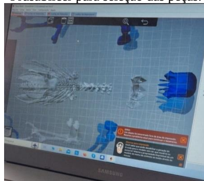
Figura 1: Realização do processo de fatiamento da peça, utilizando o software PrusaSlicer para seleção das peças.
