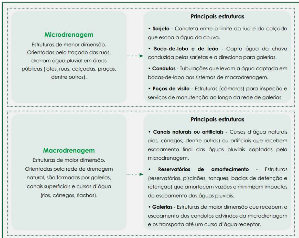
Figura 2 - Microdrenagem e Macrodrenagem
