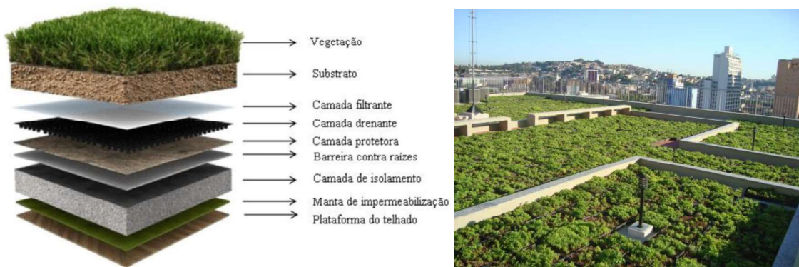
Figura 8 - Telhado verde: composição das camadas e vista superior, respectivamente
