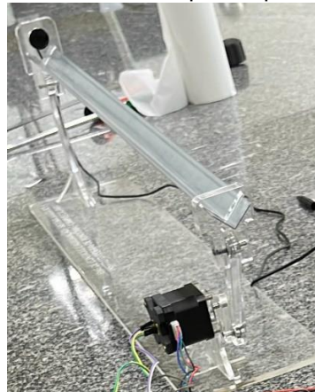
Figura 6: Sistema mecânico desenvolvido para representar o sistema barra-bola
