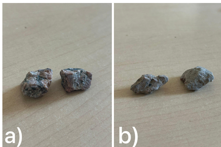
Figura 4.4 - Partículas fraturadas e partículas não fraturadas: a) Partículas fraturadas; b) Partículas não fraturadas.
