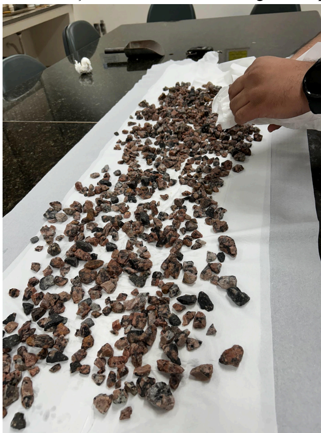
Figura 3.9 - Remoção dos filmes visíveis de água da superfície.
