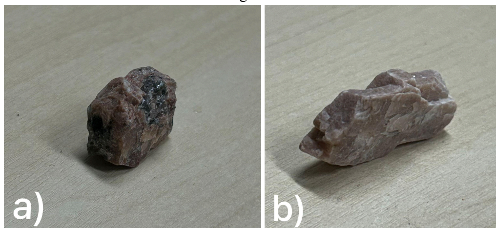
Figura 4.3 - Formas das Partículas: a) Partícula de formato cúbico; b) Partícula de formato sub-alongado.
