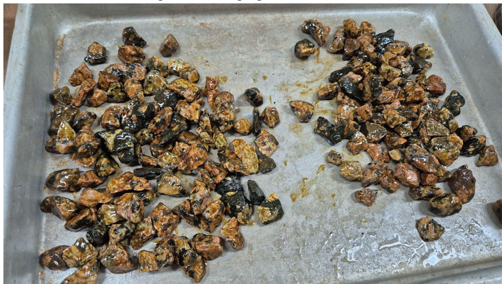
Figura 4.8 - Agregado sem aditivo.
