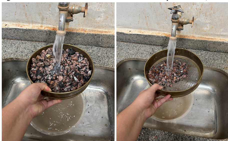
Figura 3.12 - Amostra sendo lavada com auxílio da peneira de 4,75 mm.
