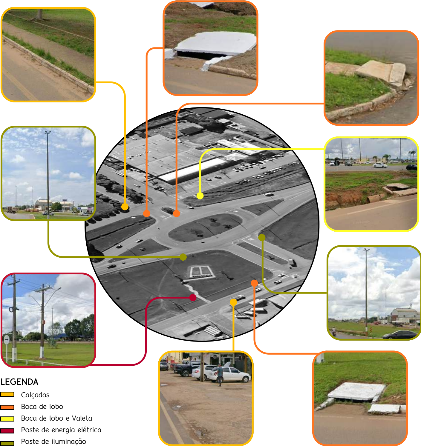
Figura 54: Mapeamento infraestrutura existente
