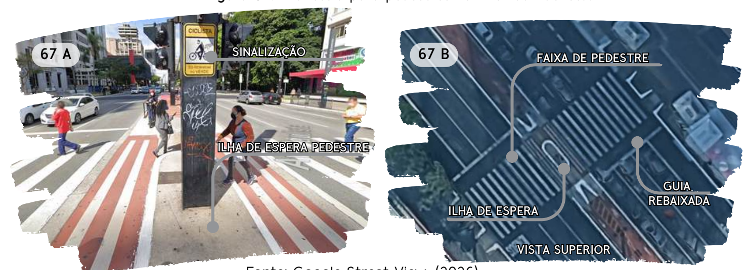
Figura 67: Travessia para pedestres na Avenida Paulista.
