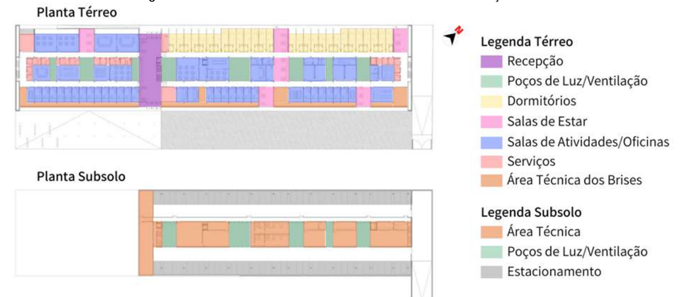
Figura 9 - Zoneamento de Atividades do Centro de Reabilitação
