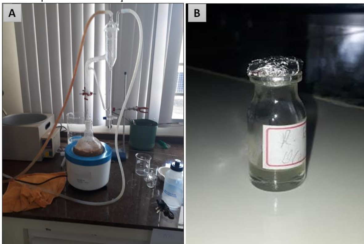
Figura 2 – (A) Aparelho para destilação Clevenger montado no laboratório para realizar a extração do óleo essencial da resina jutaicica ; (B) Amostra de óleo essencial obtido no processo de extração.
