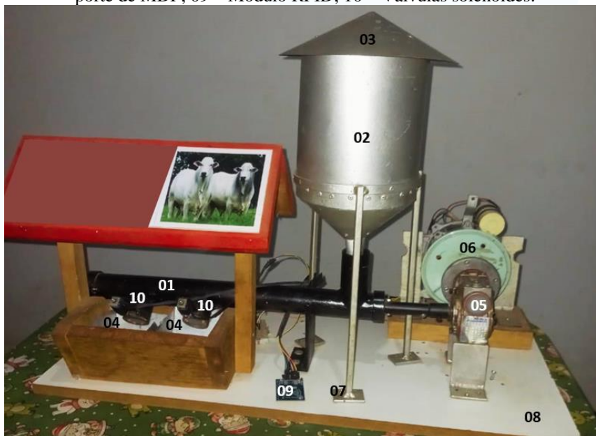
Figura 8 – Protótipo do cocho automatizado finalizado. (01 - Cilindro Metálico; 02 - Silo; 03 - Tampa do silo; 04 – Cochos metálicos; 05 - Redutor de velocidade; 06 - Motor 127V; 07 - Haste metálica; 08 - Suporte de MDF; 09 – Módulo RFID; 10 – Válvulas solenoides.
