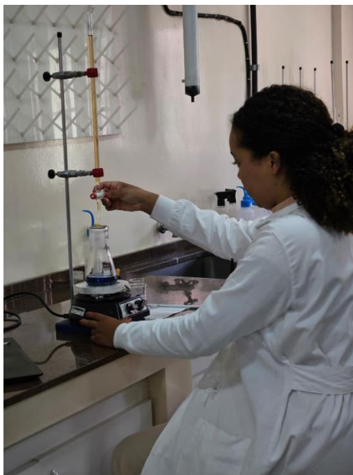
Figura 02. Titulação da amostra hidrolisada para a determinação do teor de amido, conforme o método de Lane-Eynon (Fehling). Fonte: Arquivo pessoal.
