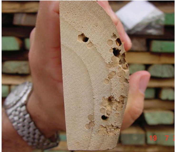
Figura 18: Galerias de S. conigerium com e sem serragem compactada na entrada das galerias.
