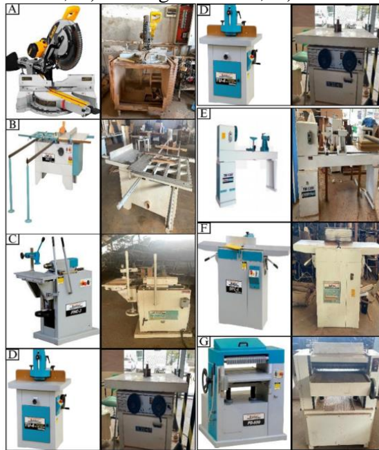
Figura 4 - Maquinários da marcenaria do IFRO. A); Serra esquadria; B) Esquadrejadeira; C) Furadeira horizontal- bancada; D) Tupia de Mesa; E) Torno para Madeira; F) Desempenadeira; G) Desengrossadeira; H) Lixadeira de Disco.
