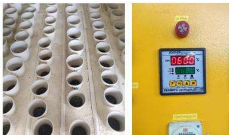
Figura 7 - Amostras dispostas na mufla após 4 horas a 600 °C.
