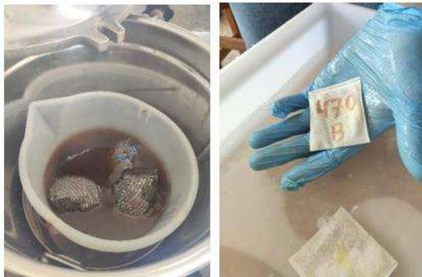
Figura 8 - Amostras na autoclave após o aquecimento e lavagem destas com acetona.
