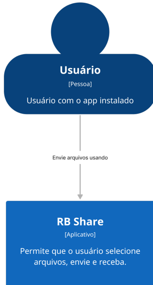
Figura 5 – Diagrama de Contexto do C4 Model ilustrando interação do sistema com usuários e sistemas externos.
