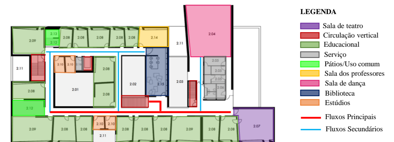
Figura 5 – Conservatório Henri Dutilleux. Layout 2º Pavimento
