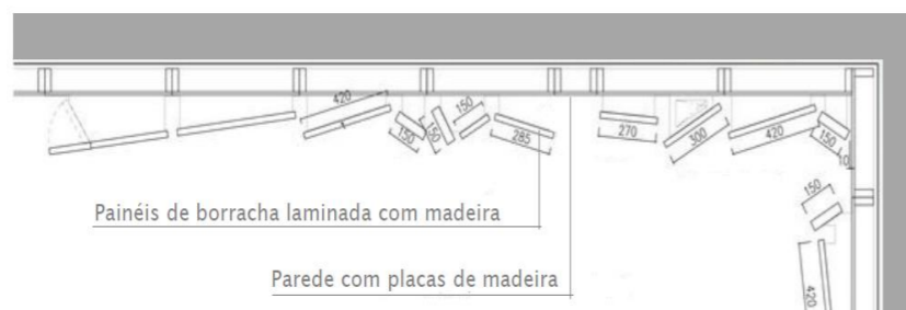
Figuras 17 – Solução acústica – Painéis de borracha articulados
