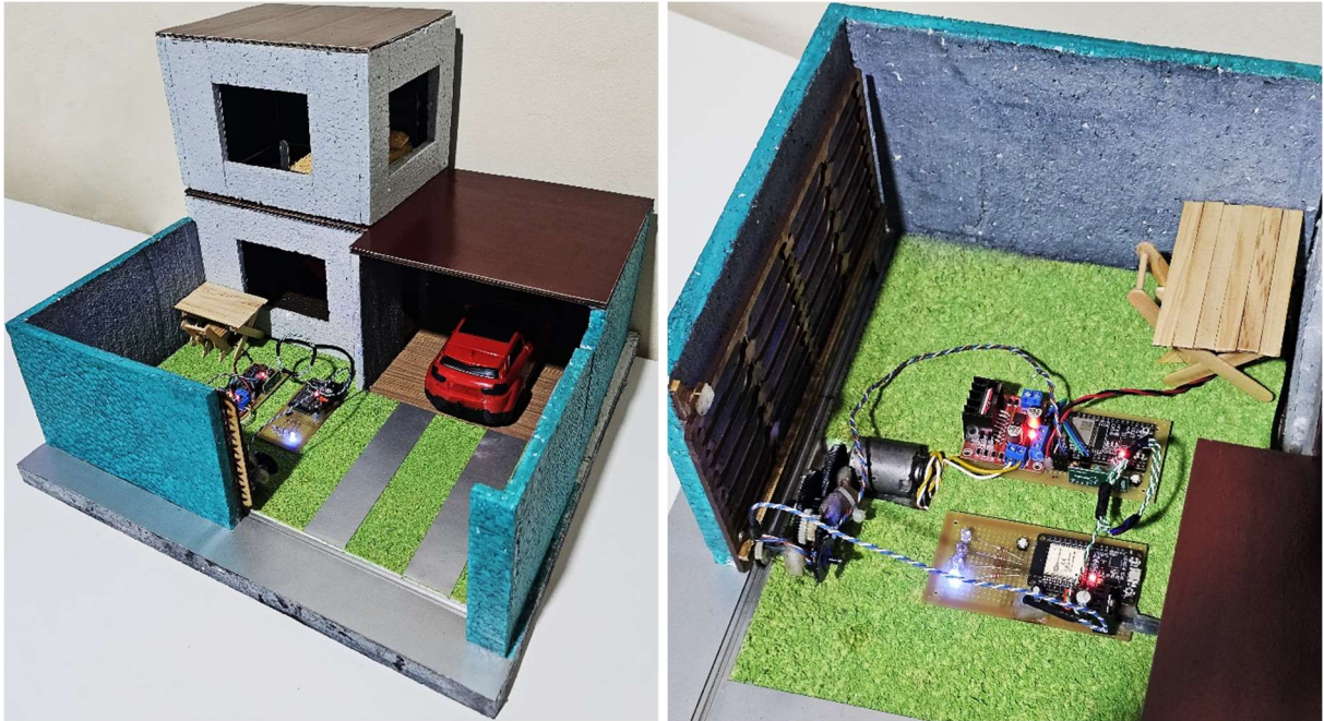
Figura 15 - Hardware ligado na réplica do portão eletrônico
