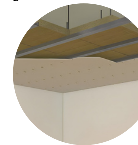
Figura 23 - Forro de gesso e lã de rocha
