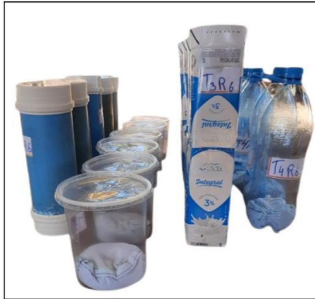
Figura 3. Areia acomodada no fundo dos silos e isolada com tecido tipo malha.
