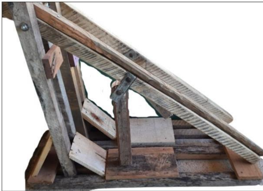
Figura 2. Prensa manual para compactação dos silos experimentais.
