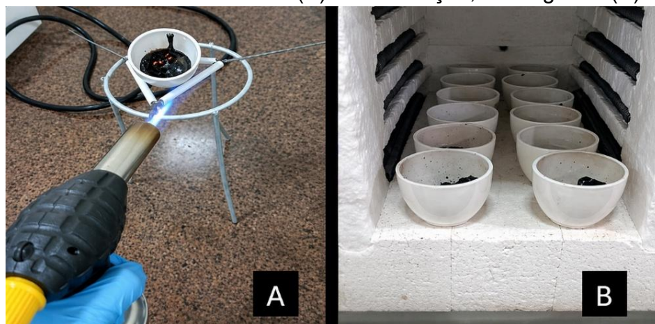
Figura 4 – Análise de teor de cinzas (A) Carbonização, e a segunda (B) Calcinação.
