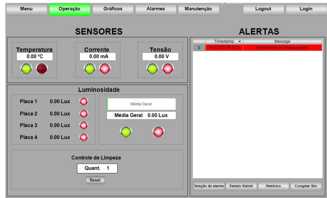
Fig. 43. Tela de Operação em funcionamento. Fonte: Autor.
